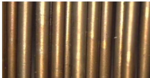
Figura 1 Las columnas MXT®-Biodiesel TG no quedan dañadas por ciclos térmicos a alta temperatura en comparación con las columnas de sílice fundida para alta temperatura las cuales se estropean bajo las mismas condiciones.
