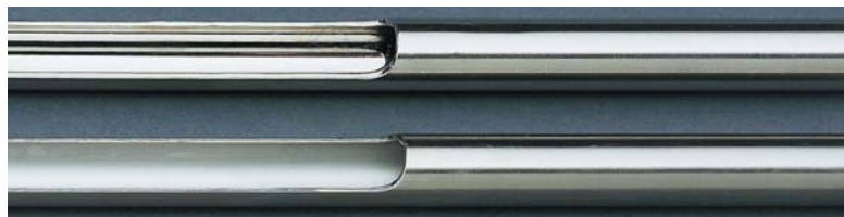
Arriba: acabado electropulido, valor medio de aspereza superficial: 5-10. Abajo: acabado convencional, valor medio de aspereza: 23-27.
